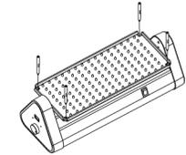
2. Setzen Sie die Doppelplattform auf die Stützen.
